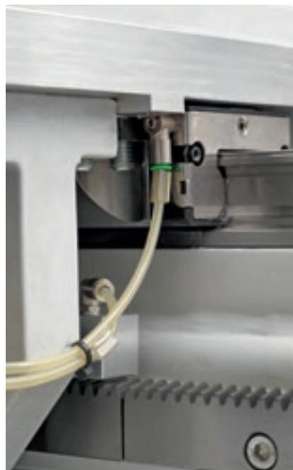
Toute la gamme Master est dotée du système intégré de graissage automatique des axes de manutention pour un entretien constant et précis au quotidien.
