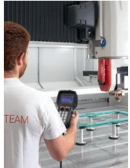
Commodité maximum des opérations grâce à la présence d'un clavier portable pour permettre:
