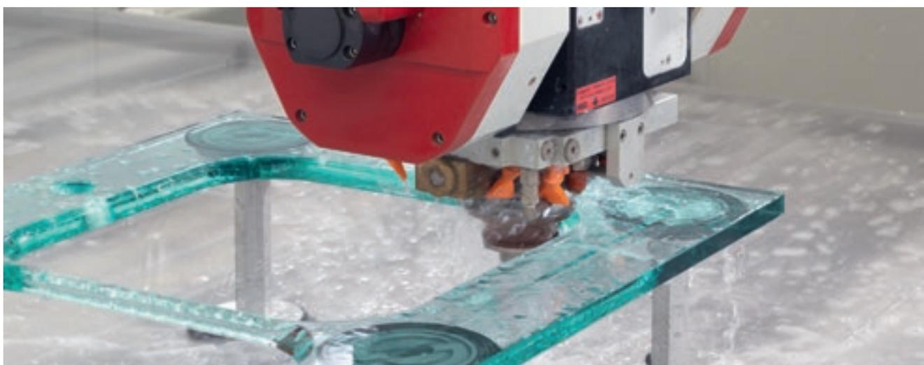
LES FAÇONNAGES À 3 AXES GARANTISSENT FIABILITÉ MAXIMALE ET PRÉCISION POUR LA RÉALISATION DE PLANS VASQUES, CABINES DE DOUCHE, VERRÉS POUR ÉLECTROMÉNAGERS.
