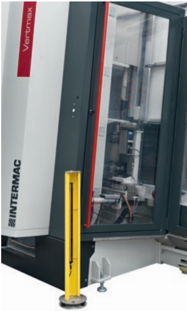
Photocellules sur les côtés de la machine et microrupteur anti-intrusion.
