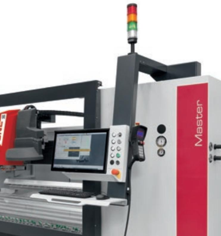
Panneau de commande intégré, avec écran tactile en option, sur le côté gauche de la machine avec possibilité de l'installer aussi sur le côté droit.
