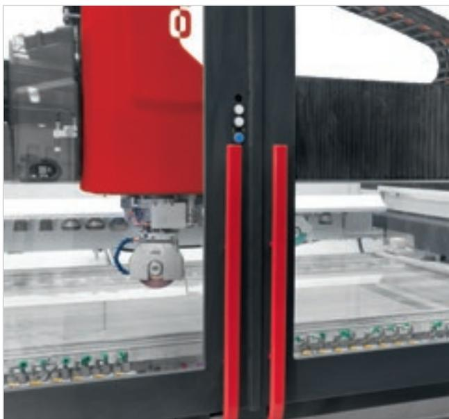
Serrure électrique de sécurité avec clavier ergonomique intégré pour l'ouverture des portes et le départ du façonnage pour une rapidité maximale et le confort de l'opérateur.
