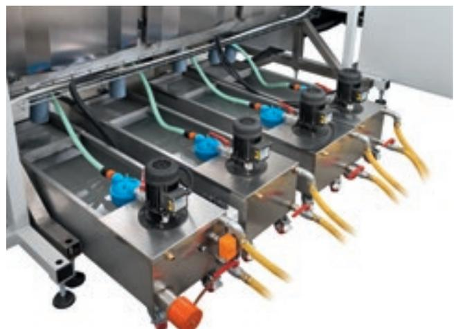
Cuves montées sur roues pour faciliter les déplacements pendant la phase de nettoyage. L'eau contenue dans les cuves passe par deux étapes différentes de filtration avant d'être recyclée dans la machine.
